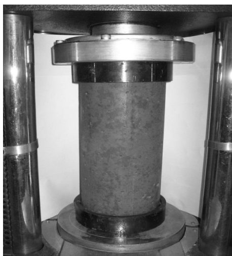
Figura 1. Configuración del ensayo de resistencia a compresión.
