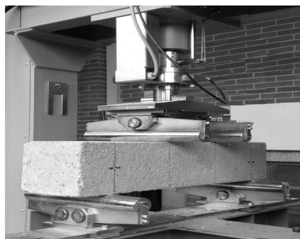
Figura 4. Configuración del ensayo de módulo de rotura.
